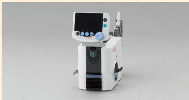
ダイヤフラム型真空ポンプと真空コントローラーNVC-3000型が一体に構成されています。省スペースで持運びも容易なので、ドラフトチャンバーや実験台を有効利用できます。各種蒸留装置と接続ができます。ポンプ電源は真空コントローラーがコントロールし、減圧時の起動や定値制御時の運転停止などを自動制御します。前面の操作部で、圧力設定、プログラム選択、データ修正などの操作が容易に行なえます。
